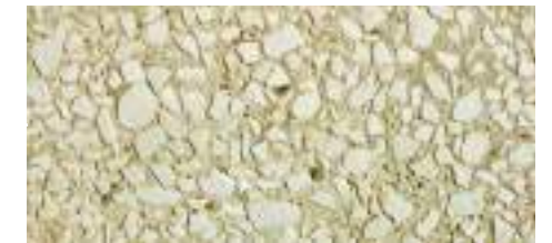
Béton de pierres calcaires, finition désactivée
