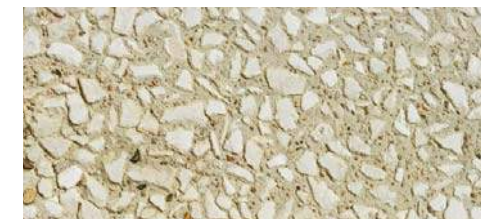
Béton de pierres calcaires, finition désactivée
