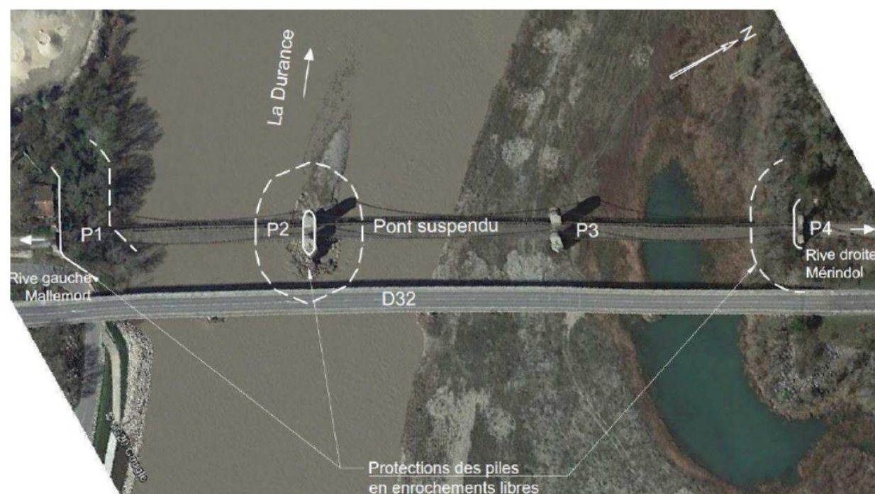
Figure 10 : Principe de protection anti-affoulement (setec Hydratec)
