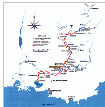
Figure 10 : carte générale de la chaîne de production hydroélectrique de la Durance
