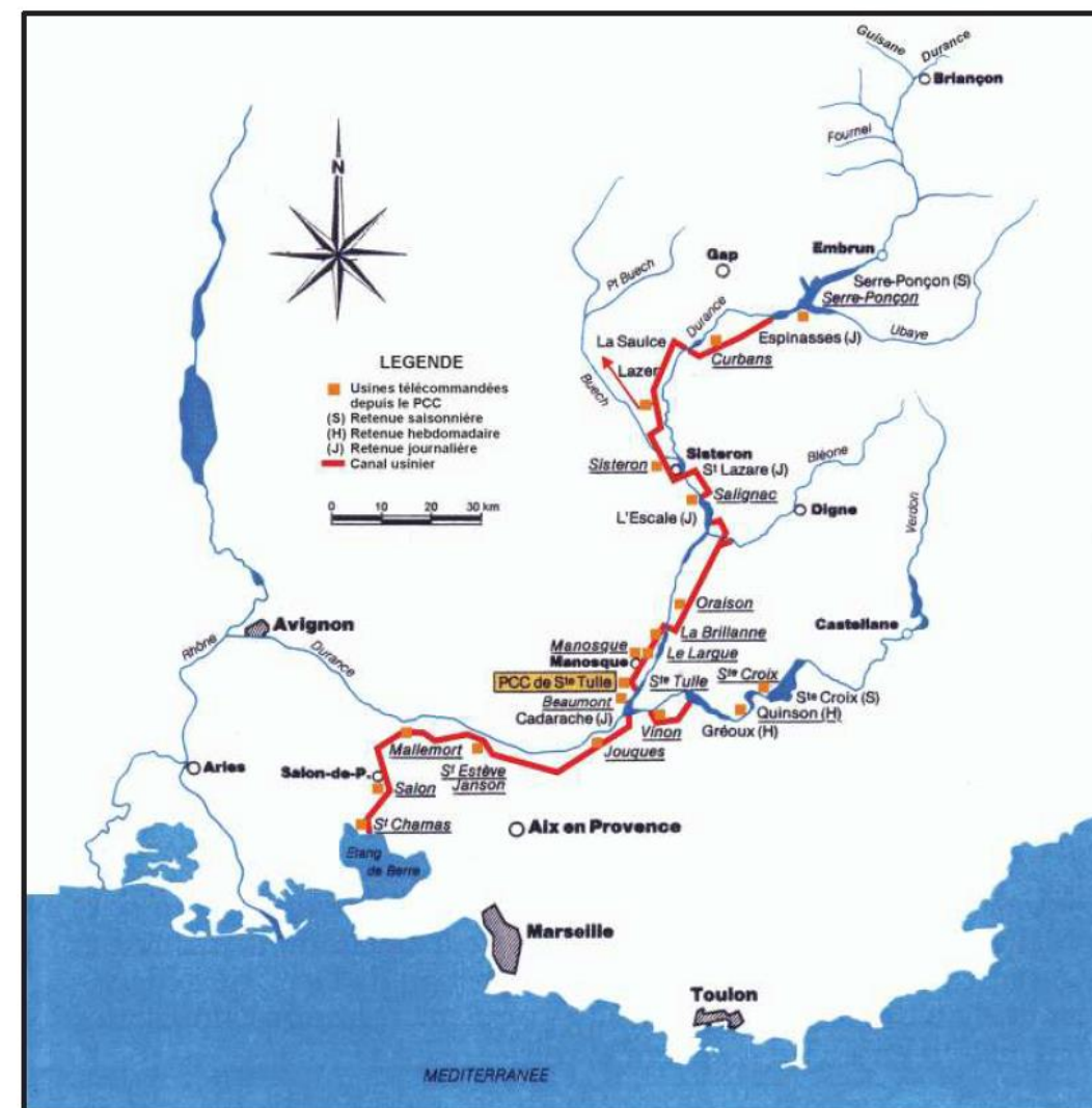
Figure 26 : Carte générale de la chaîne de production hydroélectrique de la Durance
