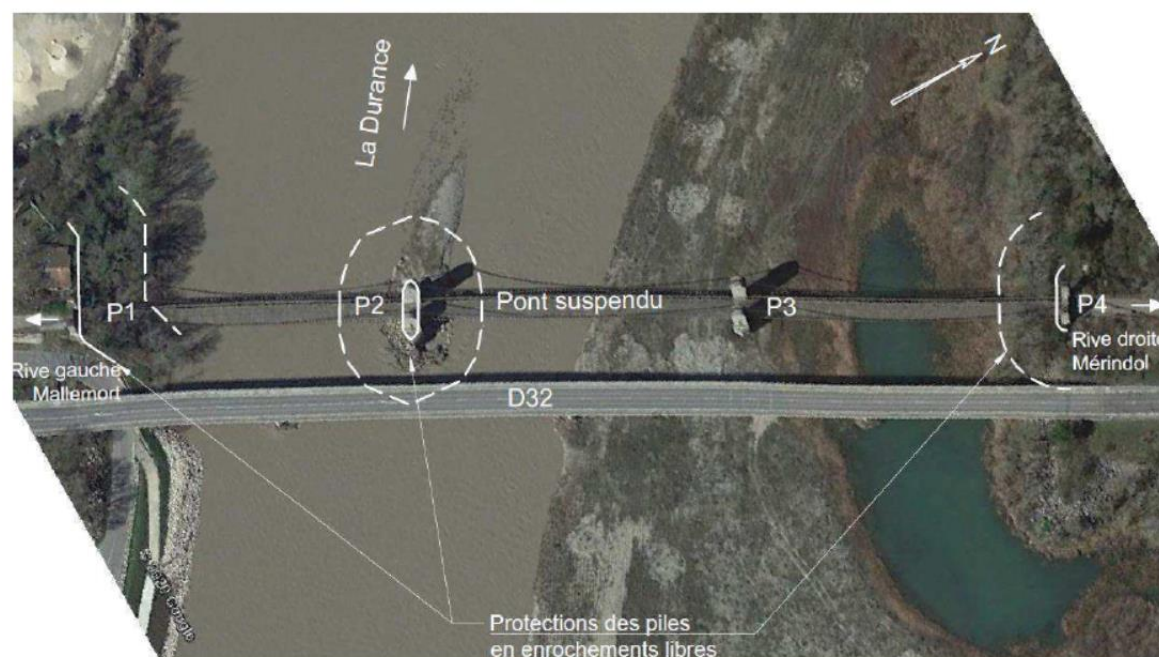
Figure 15 : Principe de protection anti-affouillement (setec Hydratec)
