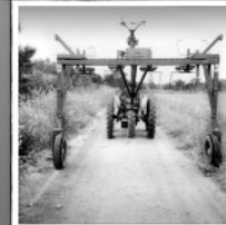
MACHINE CRÉÉE PAR REMI DURAND POUR FACILITER LE CASTRAGE DES MÂTS BAPTISÉ « LE CONCORDE » PARCE QU'IL A ÉTÉ CONÇU LA MÊME ANNÉE
