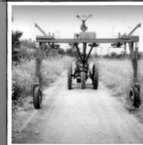
MACHINE CRÉÉE PAR REMI DURAND POUR FACILITER LE CASTRAGE DES MÂTS BAPTISÉ « LE CONCORDE » PARCE QU'IL A ÉTÉ CONÇU LA MÊME ANNÉE
