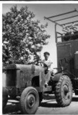
TRACTEUR MICROMAX AVEC UN MOTEUR CITROËN D14
